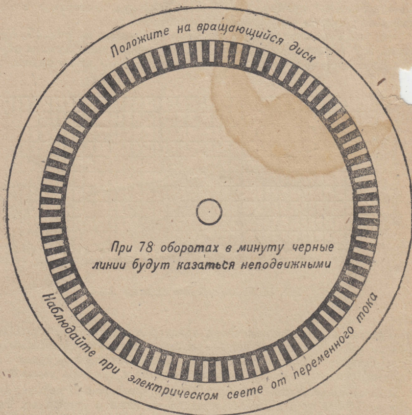
Рис. 16. Стробоскопический граммофонный диск
